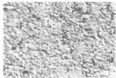
Abb. 16: EM-Aufnahme eines liposomalen Gels mit 2% Liposomen (berechnet als TS) und 5% dispergiertem Weizenkeimöl nach Gefrierätzung
